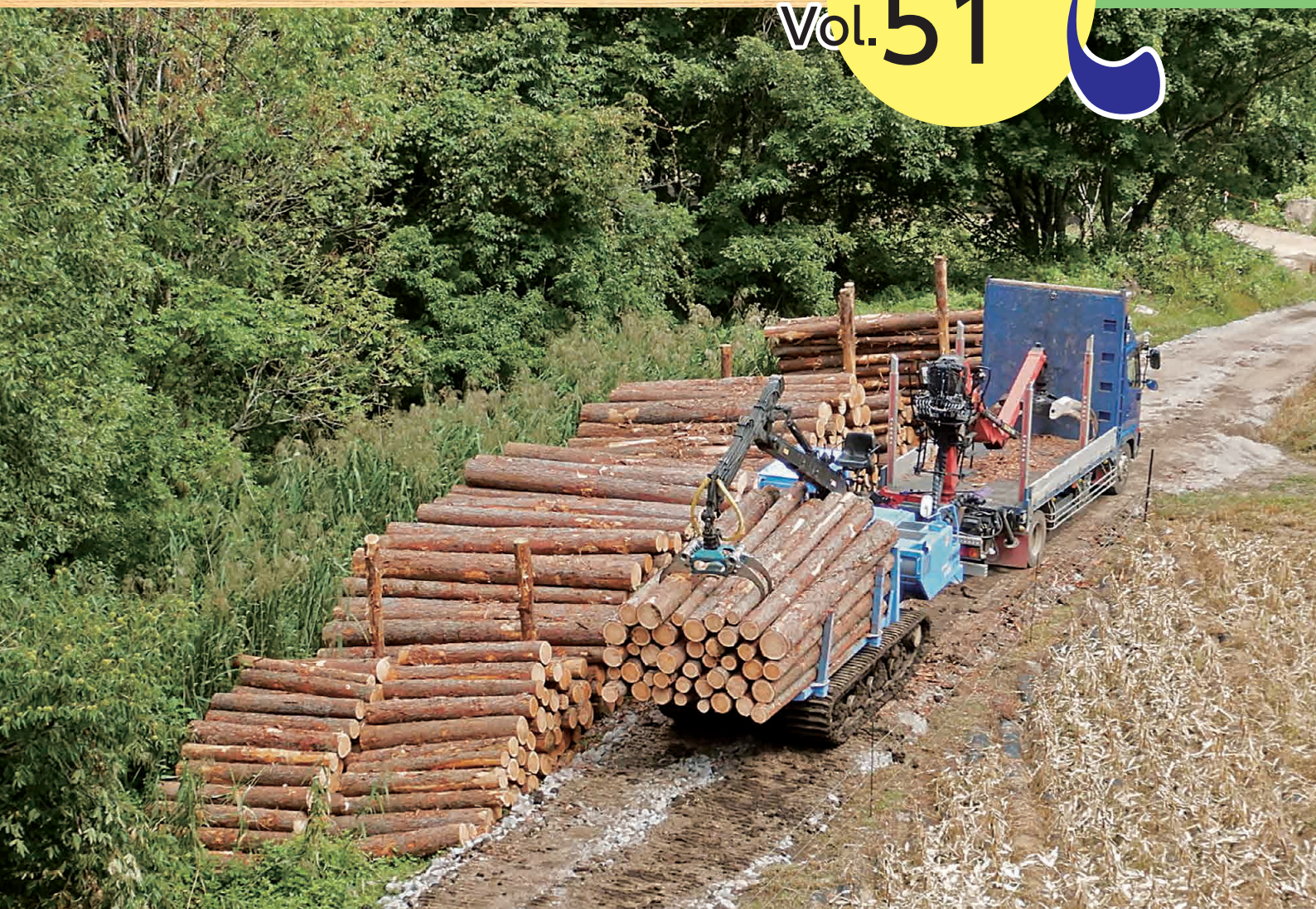
丸太の集積場所（土場） （フォワーダによる丸太運搬、大型トラックへの積み込み）
